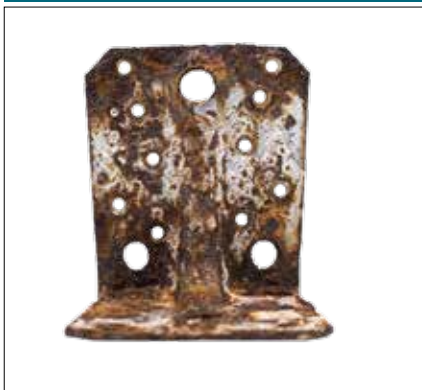
Verbinder met voorverzinkt staal Z275 Een groot deel van het verbinder is volledig verroest.
