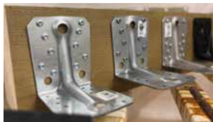
Vergelijking na 4000 uur blootstelling aan zoute nevel
