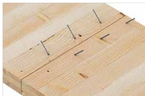
Vloer-op-vloerverbinding van dwarsgelamineerd hout met gekruiste SWD-schroeven
