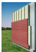
Plaatsing van een regenkap
